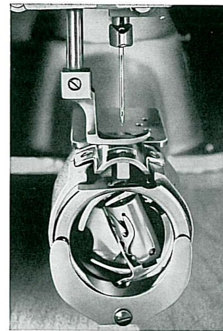
GSP 757 Bügelmappen-Garnitur Sewing foot and throat plate for sewing frames into brief cases Jeu d'accessoires pour porte-documents à poignée Dispositivo para coser asas de carteras
